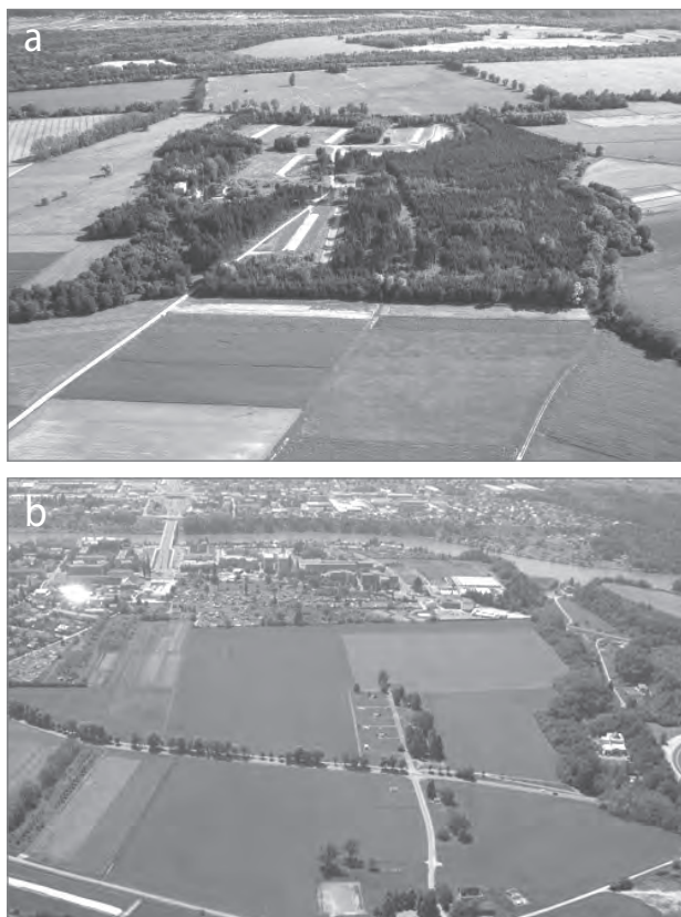
Slika 13: (a) Bogatenje z aktivno zaščito proti NO 3 , pesticidom s kmetijskih površin in podtalnice vodovoda Ormož s kakovostno kontroliranim bogatenjem iz Drave z eliminacijo Fe in Mn v vodonosniku. Varnostni pasovi, odvzeti kmetijstvu za zaščito pitne podtalnice, so nekajkrat manjši. Zaradi bogatenja zmožljivost črpališča ni odvisna od suše. (b) Črpališče regionalnega mariborskega vodovoda do 0,7 m 3 /s za več kot 200.000 prebivalcev. Črpana podtalnica na Vrbanškem platoju je pred mestom aktivno zaščiten z obrežnim filtratom Drave. Kmetijske površine na Dravskem polju niso omejene s sicer potrebnimi zaščitnimi pasovi, če bi pitno vodo črpali iz podtalnice na Dravskem polju.
