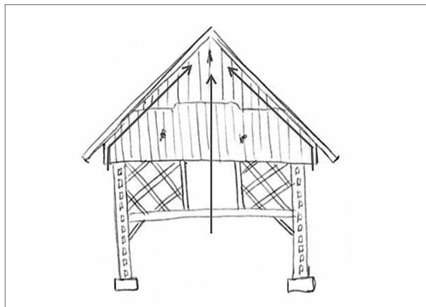
Slika 3: Gibanje zraka v kozolcu (ilustracija: Nika Marn)
