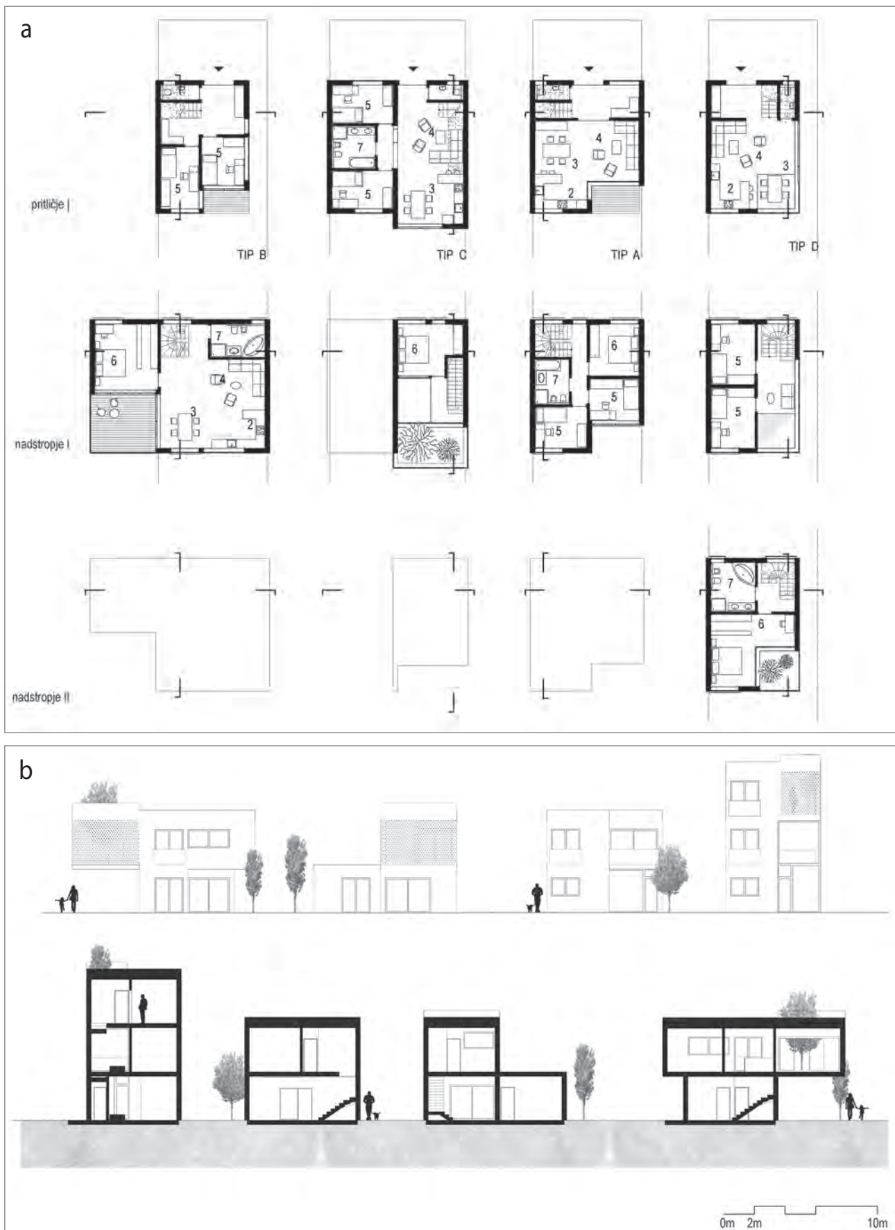
Slika 7: (a) Tlorisi vrstnih hiš v sosesk, (b) pročelja proti vrtu in prerezi vrstni hiš v sosesk (ilustracija: Sanja Špindler)
