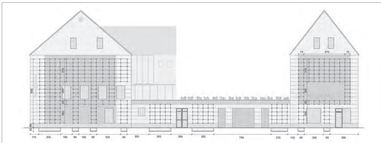
Slika 7: Stena, ozelenjena z vzpenjalkami in stensko oporo
